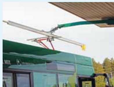
Hybricon Arctic Whisper är namnet på den snabbbladdade elbussen som Nobina kör mellan Umeå Airport och Umeå central. Bussen är specialanpassad för vårt nordiska klimat.
